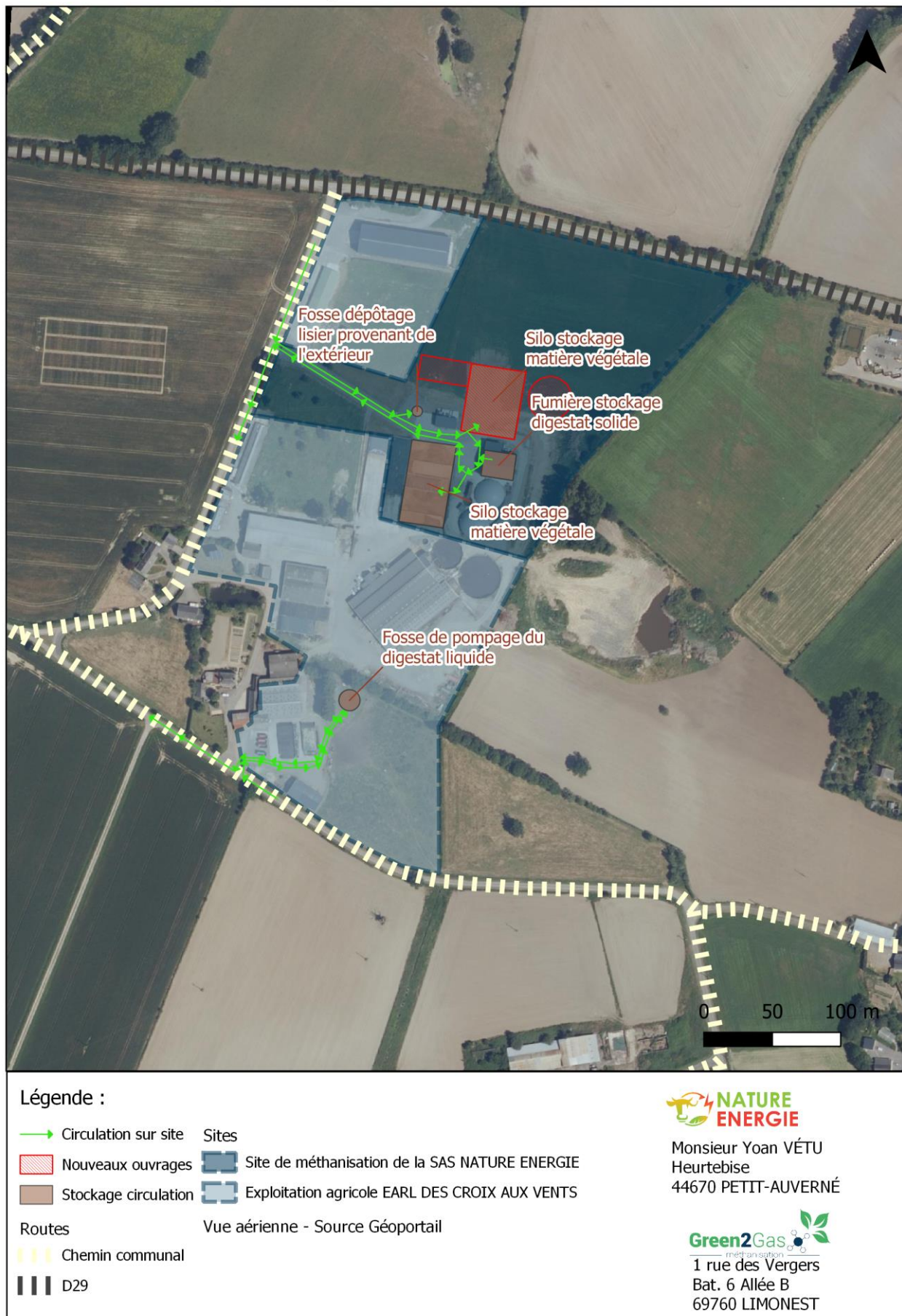
Figure 37 : Accès des matières importées et exportées sur le site de méthanisation de la SAS NATURE ENERGIE
