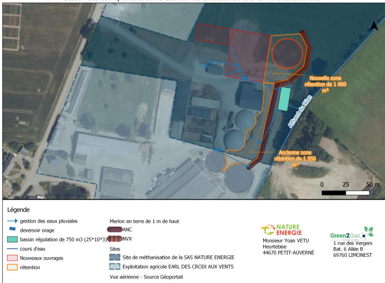
Figure 40 : Gestion des eaux pluviales sur le site de méthanisation de la SAS NATURE ENERGIE
