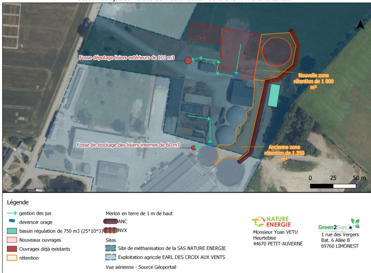
Figure 39 : Gestion des jus de silos sur le site de méthanisation de la SAS NATURE ENERGIE
