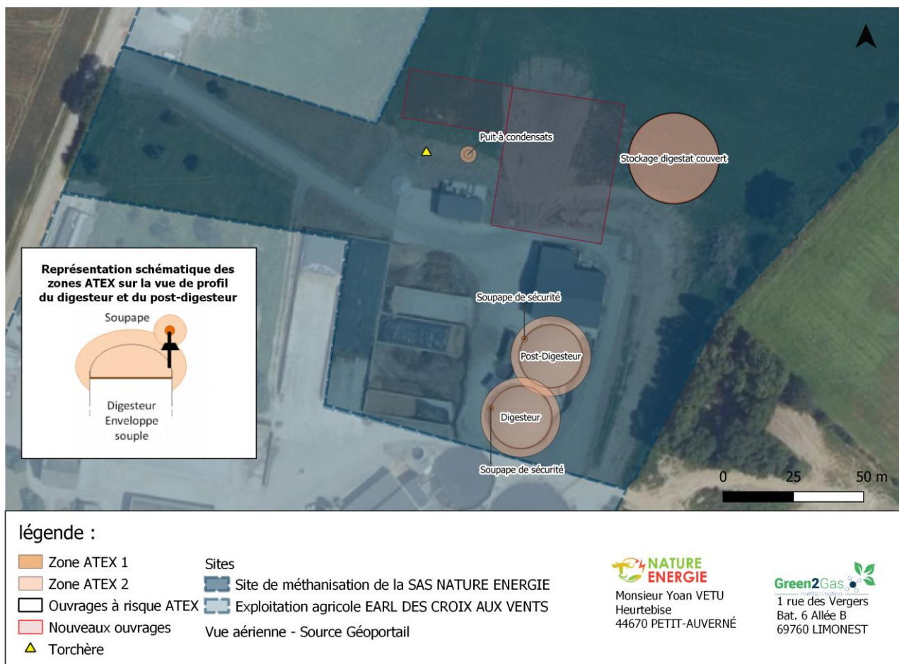
Figure 41 : Identification des zones ATEX sur le site de méthanisation de la SAS NATURE ENERGIE
